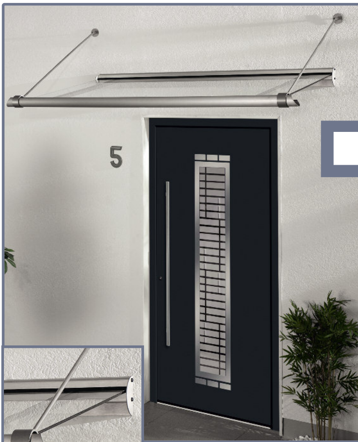
Abb.: Elegantes Aluminium-Leichtpultdach „ALPHA“ mit V2A-Wandabhängungen, Dachneigung 10° (nicht veränderbar), Dachbreite max. 2250 mm, Dachtiefe max. 950 mm, Farbton Edelstahloptik, VSG-Verglasung
