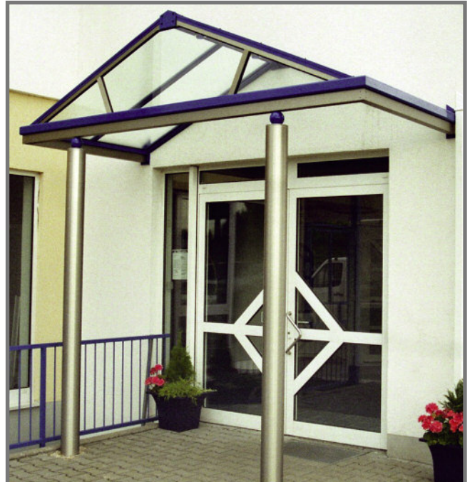
Vordachsystem „FRANKFURT“ als Aufmaßkonstruktion mit statischen Verstärkungen und Frontverglasung, Rinnenprofil 3-seitig umlaufend, Rundstützen mit Zierkugeln, Bicolor-Ausführung, Farbton Edeldahlstahl/RAL 5003, VSG-Verglasung.
