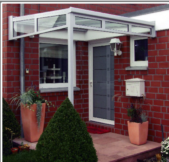
Abbildung: Modell „KARLSRUHE 1“ als Aufmaßkonstruktion, Ecklösung, Schürzenprofile zusätzlich untergesetzt, RAL 9006, VSG-Verglasung.
