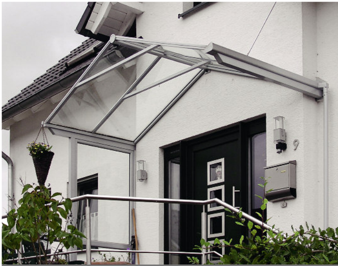
Vordachsystem „FRANKFURT“ als Aufmaßkonstruktion mit statischen Verstärkungen, Abspannung über V2A-Zugstrebe zusätzlich, Fallrohranschluss wandseitig, Trennwandsystem links, RAL 9006, VSG-Verglasung.
