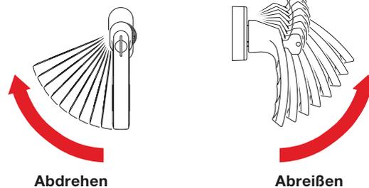
Die Secustik®-Technik erschwert nachhaltig ein unbefugtes Verschieben des Fensterbeschlages von außen durch den integrierten Sperrmechanismus. Seine feine Rastung ist das akustische Signal für mehr Basis-Sicherheit.
